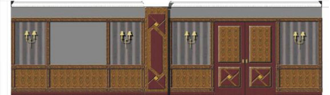
شكل (١٢) مسقط رأسي (C-C) (رسم هندسي) بالقاعة متعددة الأغراض حيث يوضح تصميم حائط المدخل للقاعة من الداخل
